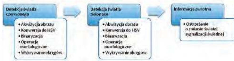
Rys. 4. Schemat algorytmu do wykrywania zmiany światła sygnalizacji ulicznej Fig. 4. Schema of traffic lights change detection algorithm
