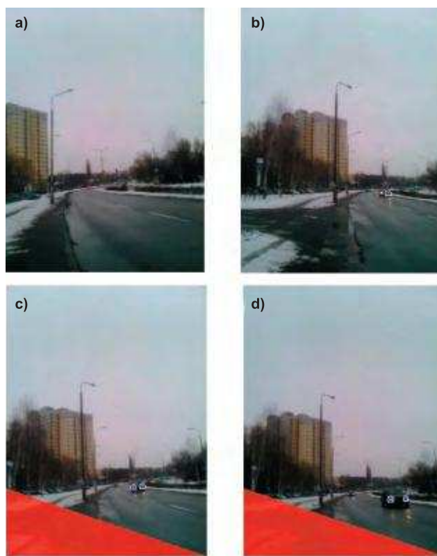
Rys. 9. Przykładowy proces wykrywania pojazdu: a) pojazd jest zbyt daleko od obiektywu, b) wykryty jest jeden reflektor, c) i d) wykryte są dwa reflektory i wyświetlone zostaje graficzne ostrzeżenie Fig. 9. Illustrative process of vehicle detection: a) vehicle is too far to camera, b) one light is detected only, c), and d) two lights are detected and warning is displayed
