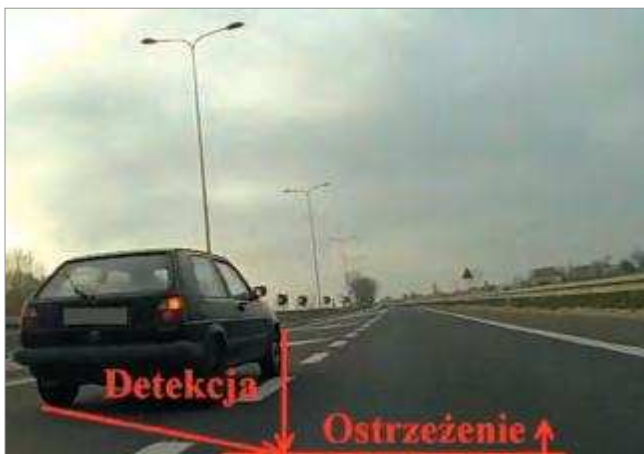
Rys. 2. Koncepcja systemu wspomagającego kierowcę we właściwym stosowaniu „metody zamka błyskawicznego” Fig. 2. Concept of the driver assistance system for proper use the “late merge scheme”
