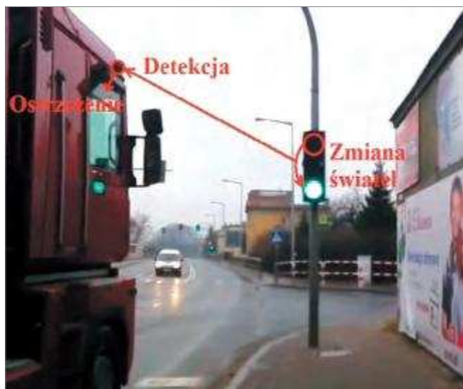
Rys. 1. Koncepcja systemu wspomagającego kierowcę w bezwłocznym ruszeniu pojazdu Fig. 1. Concept of the driver assistance system for starting the vehicle movement without delay
