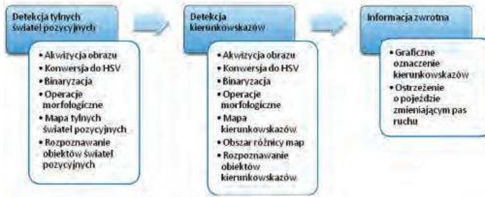
Rys. 5. Schemat algorytmu do wykrywania włączonych kierunkowskazów Fig. 5. Schema of algorithm for detection of turn signaling lights
