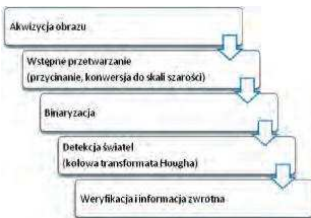
Rys. 6. Schemat algorytmu do wykrywania nadjeżdżających pojazdów Fig. 6. Schema of algorithm for detection of approaching vehicle
